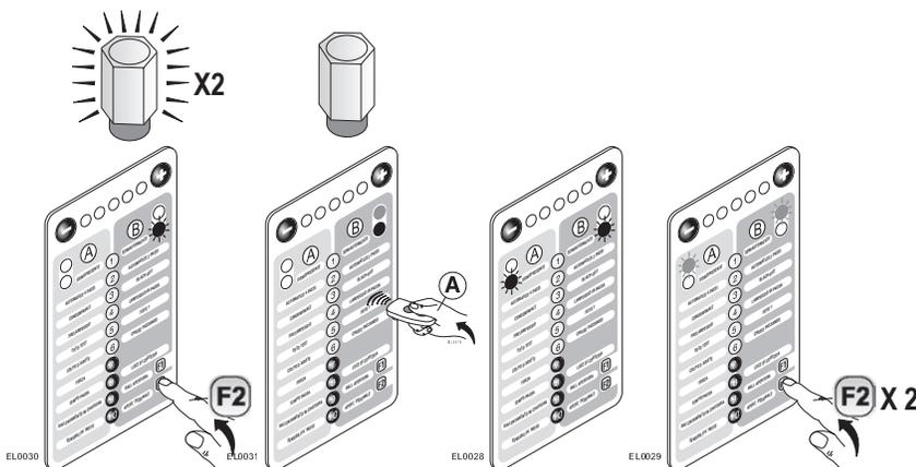
1) Apasand **F2** se aprinde ledul rosu (DX) cu iluminare lenta si lampa de semnalizare SPLENDOR (daca este prevazuta) cu iluminare dubla.
